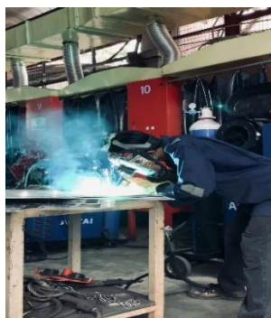
Gambar. 3 Proses Pengelasan GMAW Aluminium posisi 1G
