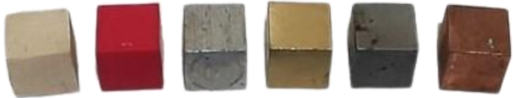
Gambar 15. Beban Percobaan modul Koefisien Gesek dan GJB
