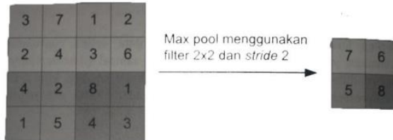
Gambar 16 Teknik max pooling [18]
