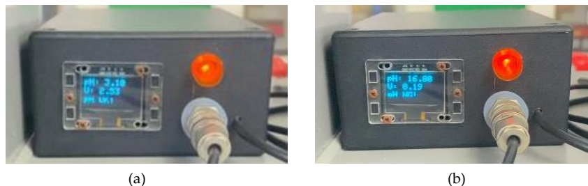
Gambar 6. (a) Tampilan kondisi normal pada tank 10B (b) Tampilan kondisi abnormal pada tank 10B.
