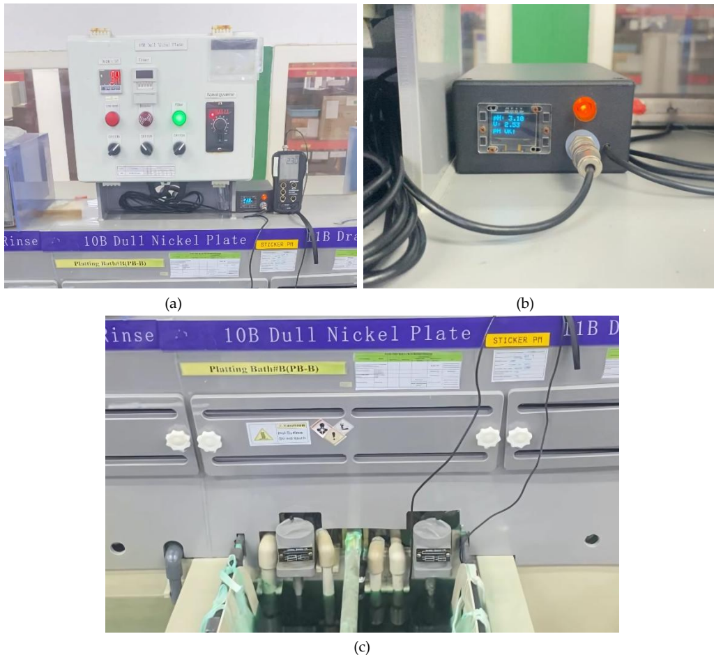
Gambar 4. (a) Penempatan Alat (b) Close up alat (c) Penempatan pH electrode .
