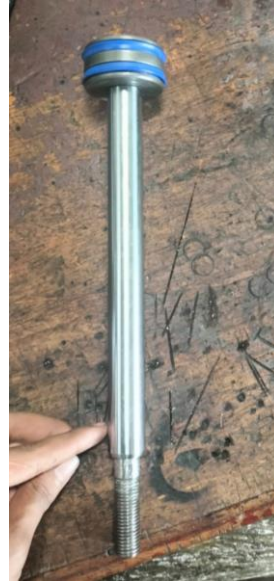
Gambar 8. Seal Piston Sudah Terpasang Piston
