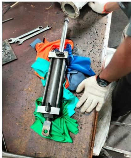
Gambar 15. Silinder Terpasang Kembali
