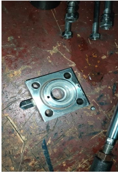
Gambar 10. End Cap Sebelum Pasang Seal
