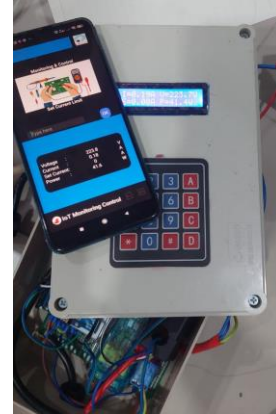
Gambar 6. Alat kontrol dan monitoring penggunaan daya dan arus listrik berbasis IoT
