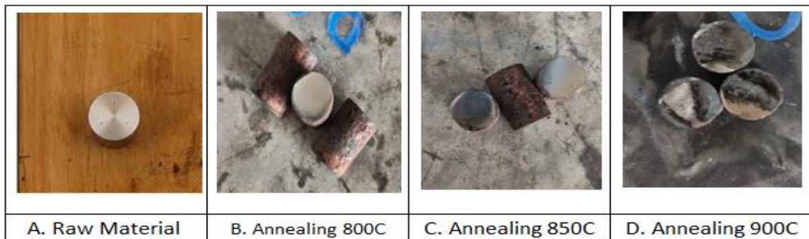
Gambar 5 Kondisi Fisik Permukaan Spesimen Sebelum ( raw material ) Dan Sesudah Perlakuan Panas
