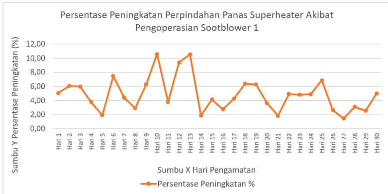
Gambar 16. Grafik Persentase Peningkatan Perpindahan Panas Superheater Akibat Pengoperasian Sootblower ke-1 di bulan november.
