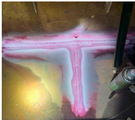
Gambar 3. 14 Melakukan Pembersihan Pada Area Welding yang sudah dilakukan pengaplikasian Cairan Penetrant dengan menggunakan Cleaner dan Melakukan Penyemprotan Cairan Develover (Gambar Pribadi)
