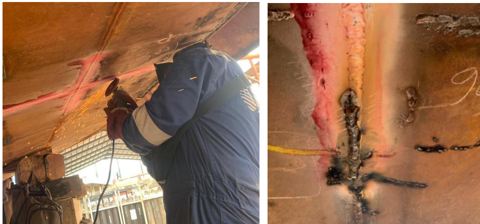
Gambar 4. 12 Proses Perbaikan(Repair) Pada Sambungan Las Yang Memiliki Cacat Permukaan Yang Melewat Batas Toleransi (Gambar Pribadi)
