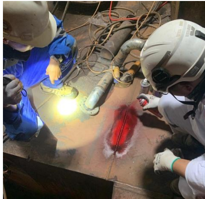
Gambar 3. 13 Melakukan Pembersihan pada Area Welding yang Sudah di Brus Menggunakan Cleaner dan Melakukan Pengaplikasian Cairan Penetrant Pada Area Welding (Gambar Pribadi)
