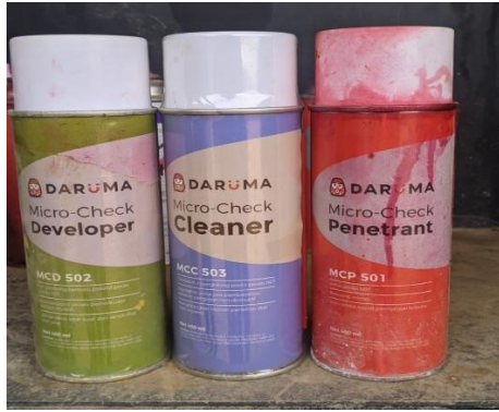
Gambar 3. 6 Develover(Hijau), Cleaner(Biru), Penetrant(Merah) (Gambar Pribadi)
