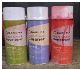
Gambar 3. Cleaner, Developer, dan Penetrant yang digunakan pada pengujian Penetrant Test
