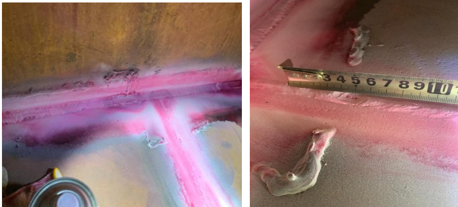
Gambar 4. 8 Hasil Penetrant pada Sampel 2 – T-Joint Area Tank Top (Gambar Pribadi)
