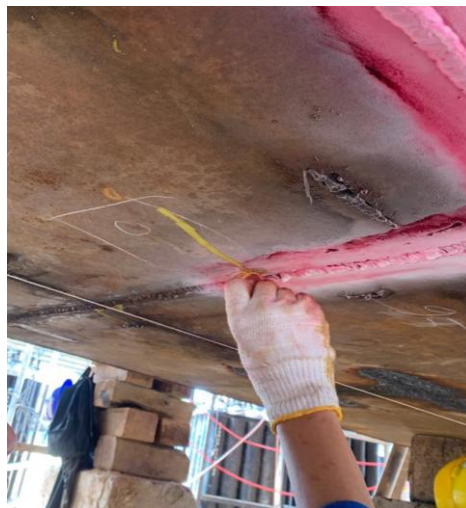
Gambar 3. 15 Melakukan Pemeriksaan Visual Pada Area Yang Sudah Dilakukan Pengaplikasian Cairan Develover (Gambar Pribadi)
