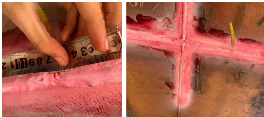
Gambar 4. 10 Hasil Penetrant pada Sampel 4 – Cross Joint Area Bottom (Gambar Pribadi)
