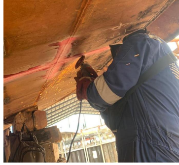
Gambar 9. Proses perbaikan ( repair ) pada indikasi cacat hasil Penetrant Test
