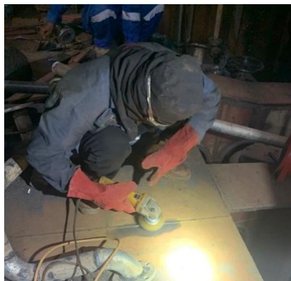
Gambar 3. 12 Melakukan Penggerindaan Menggunakan Mata Gerinda Brus untuk Membersihkan Area Welding yang akan Dilakukan Pengujian Penetrant Test (Gambar Pribadi)
