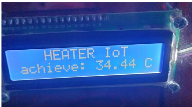
(Gambar 15. Output Pada LCD 16x2 Archieve Room)
