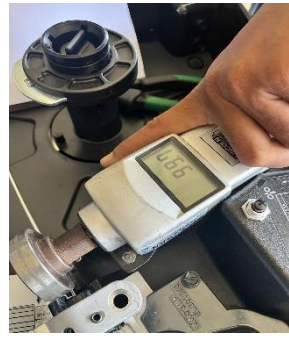
(d) Alat Ukur Pengukuran WFS Welding Equipment
