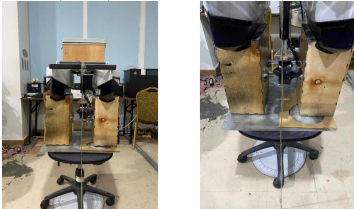
Gambar 12. Pengujian Sudut Heading ASV
