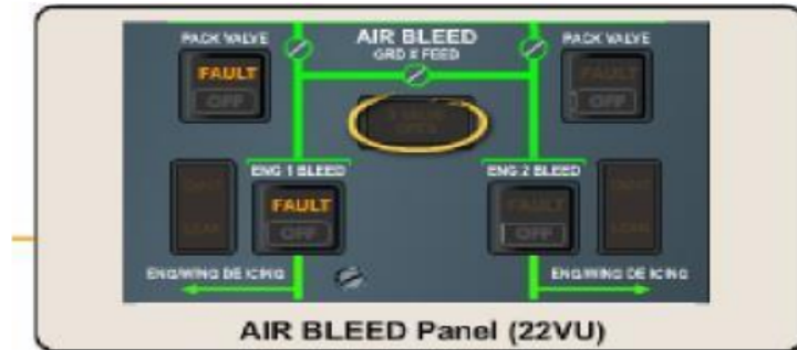
Gambar 3. Indikasi eng 1 fault pada overhead panel
