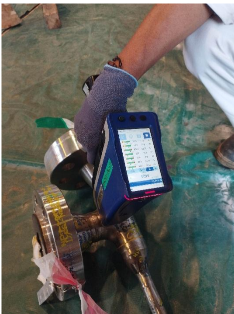
Gambar 6a: Pengujian PMI XRF
