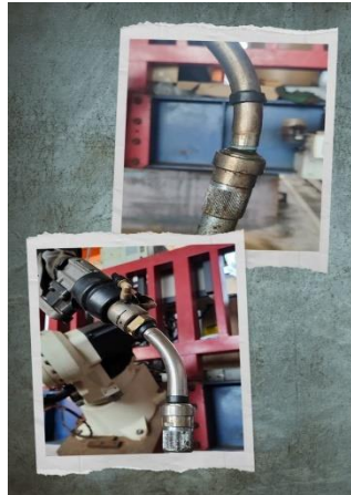
Gambar 4. Torch robotic yang menyebabkan eror
