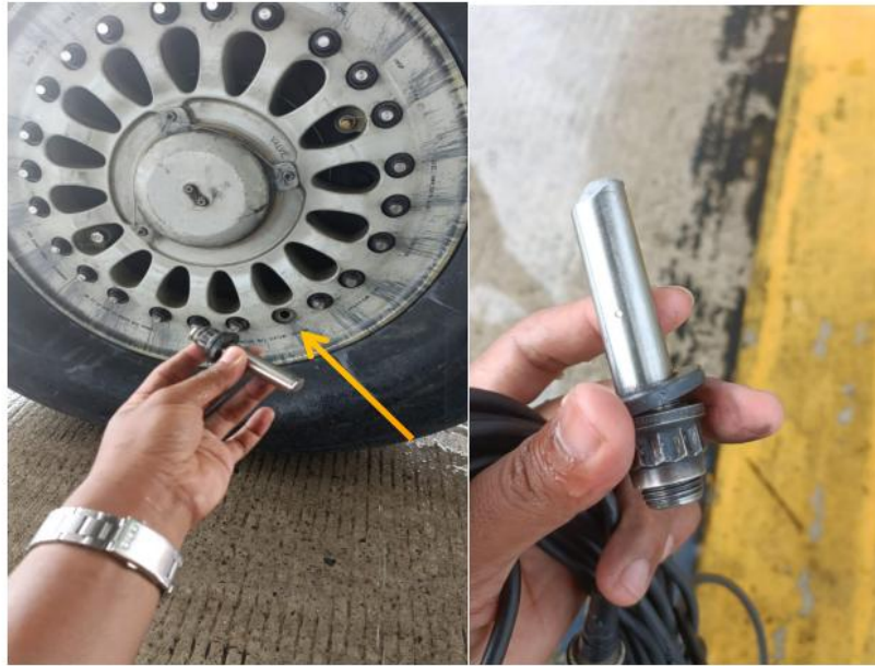
Gambar 3 : Kondisi Baut Roda Pesawat Patah
