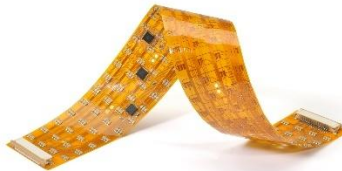
Gambar 2.8. contoh PCB flex pada monitor (sumber: https://yic-asm.com/flexible-circuit-boards/ )
