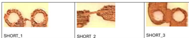
Gambar 3.11. klasifikasi short circuit
