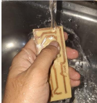
Gambar 3.6. PCB dibersihkan dari sisa cairan kimia pasca proses etsa(etching)
