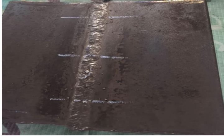
Gambar 4.4 Hasil Pengelasan Dengan Elektroda E7018 Sudah Dioven
