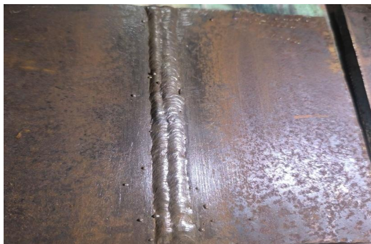
Gambar 4.5 Hasil Pengelasan Dengan Elektroda E7016 Basah Terkena Air
