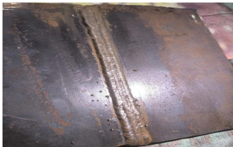
Gambar 4.1 Hasil pengelasan Dengan Elektroda E7016 Baru Dari Kotak
