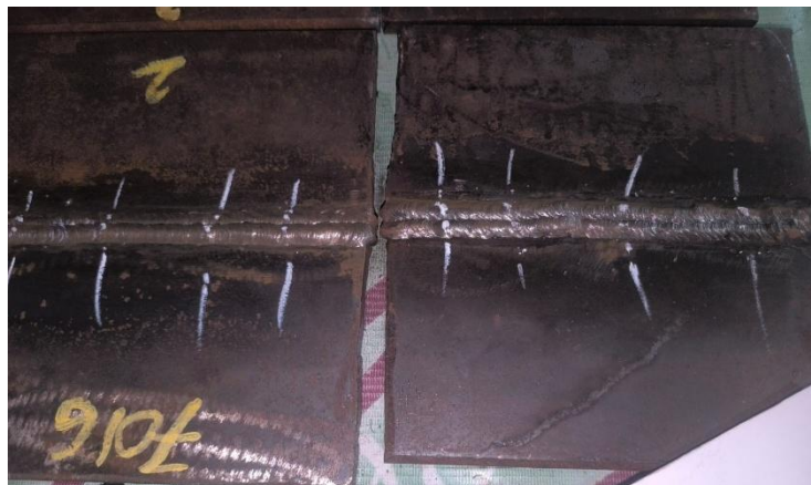
Gambar 4.3 Hasil pengelasan Dengan Elektroda E7016 Sudah Dioven
