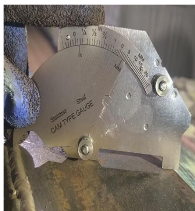
Gambar 3. 5 Proses Inspeksi Visual Keseluruhan Spesimen Uji
