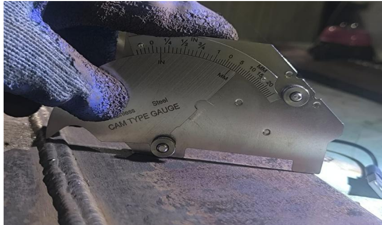
Gambar 4.2 Hasil Pengelasan Dengan Elektroda E7018 Baru Dari Kotak
