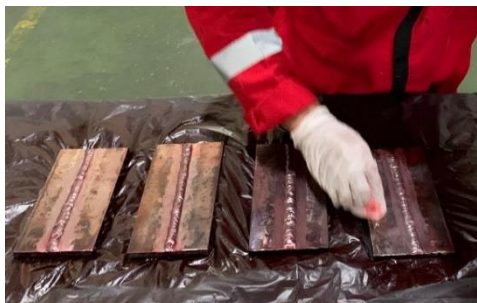
Gambar 4: Pembersihan sisa penetrant
