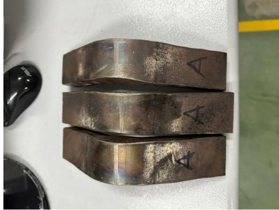
Gambar 5. Hasil pengujian bending pada pengelasan fcaw full co2
