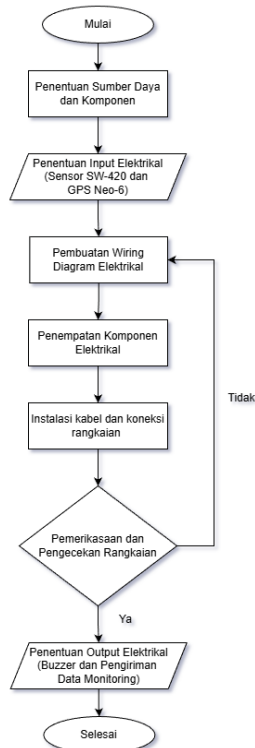
Gambar 11. Flowchart Perancangan Elektrikal
