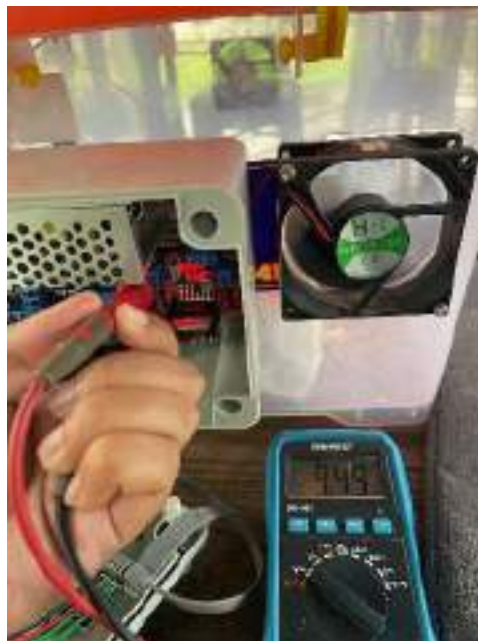
Gambar 24. Pengukuran output voltage fan speed menggunakan multimeter
