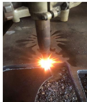
Gambar 11. Proses pemanasan plat sebelum melakukan pemotongan
