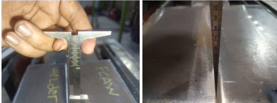
Gambar 5. Pengukuran Hi-lo dan juga Lebar Gap
