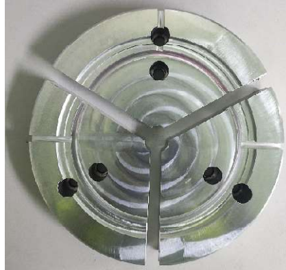
Gambar 9. Hasil proses fabrikasi soft jaws dual fungsi
