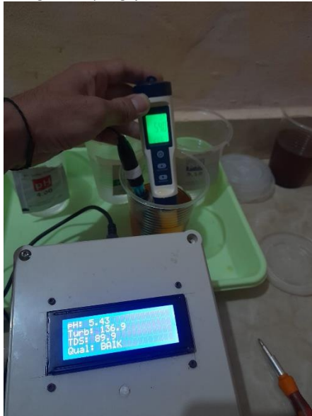
E. Berikut adalah gambar pengujian sensor PH Air Mineral
