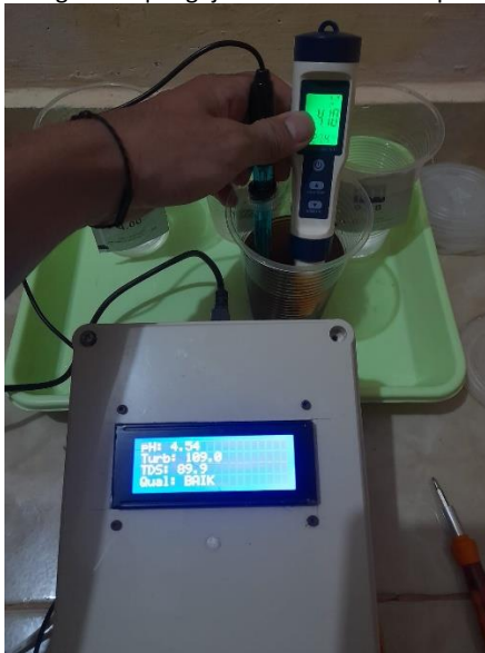
G. Berikut adalah gambar pengujian sensor TDS 1382ppm
