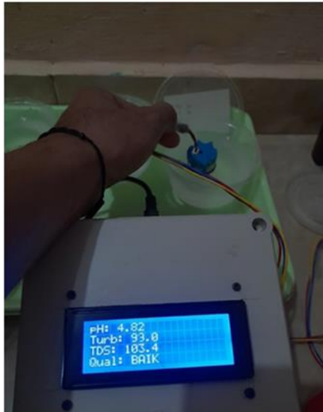
H. Berikut adalah gambar pengujian sensor Turbidity 100 NTU
