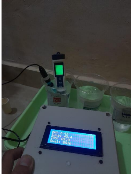
D. Berikut adalah gambar pengujian sensor PH Air Teh
