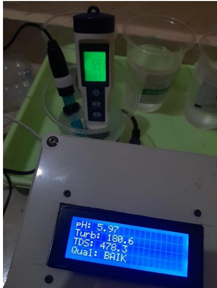
F. Berikut adalah gambar pengujian sensor PH Air Kopi
