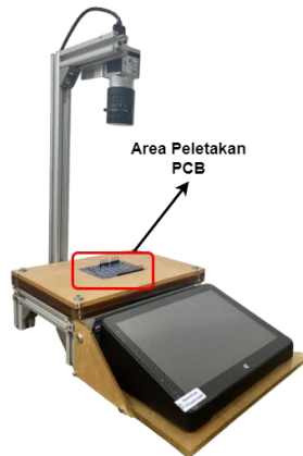
Gambar 8. Penempatan sampel PCB pada alat inspeksi.
