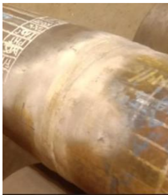
Gambar 3: Welding Profile setelah di MPI
