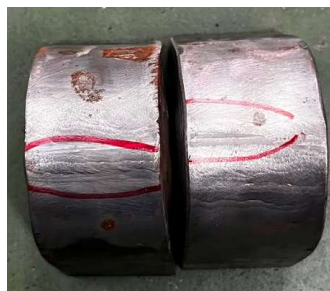
Gambar 23. Spesimen Pengujian Bend 3
