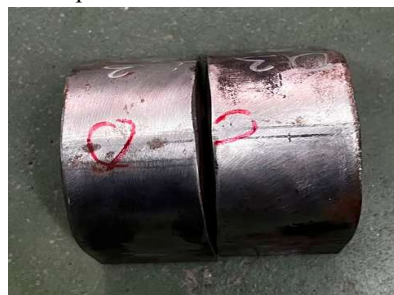
Gambar 21. Spesimen Pengujian Bend 1
