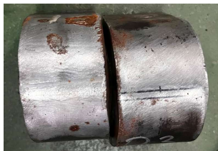
Gambar 22. Spesimen Pengujian Bend 2
