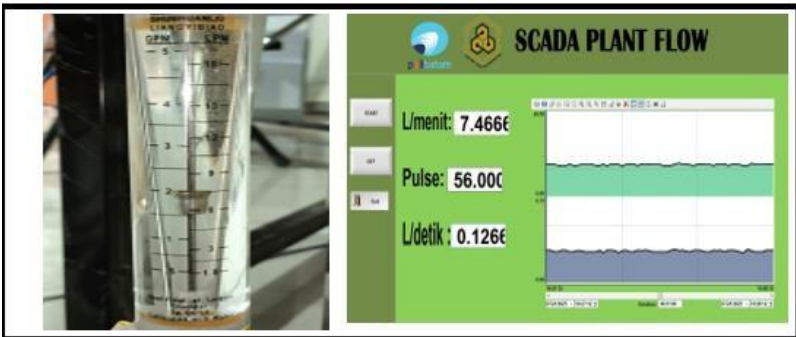
Gambar 10 Pengujian Pompa Kec 2'
