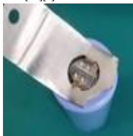
Gambar 7 : hasil las yang kurang sempurna
