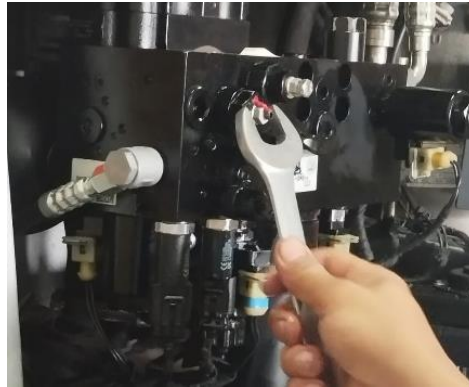
Gambar 2. Pembongkaran dan pembersihan katup
