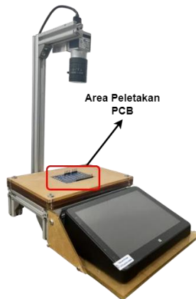
Gambar 8. Penempatan sampel PCB pada alat inspeksi.
