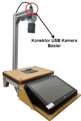
Gambar 4. Koneksi kamera Basler ke USB.
