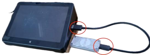
Gambar 5. Koneksi Coral USB Accelerator ke tablet PC.
