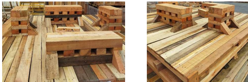
Gambar 14: Hasil Fabrikasi Kayu Pinus Menjadi Sebuah Palet
