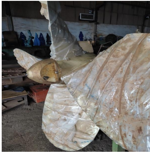
Gambar 3.6 Pemasangan Nut Propeller
