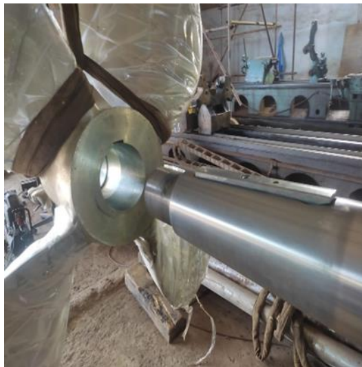
Gambar 3.5 Pemasangan propeller pada shaft
