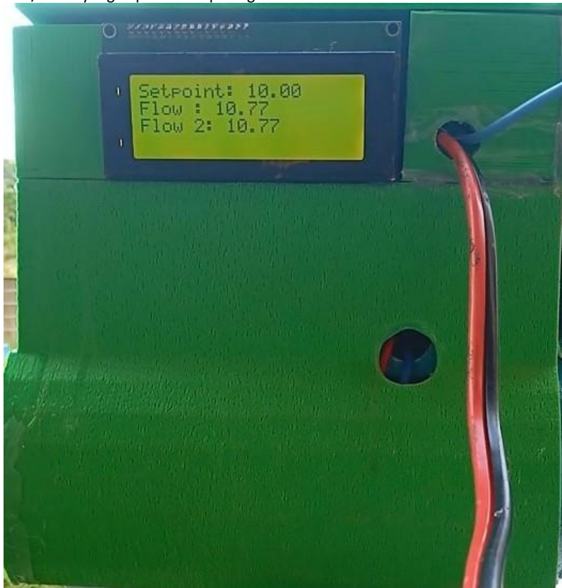
Gambar 17. Data LCD Pada Pompa Air
