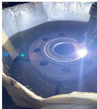
Gambar 11. Flange yang sedang diproses cladding
