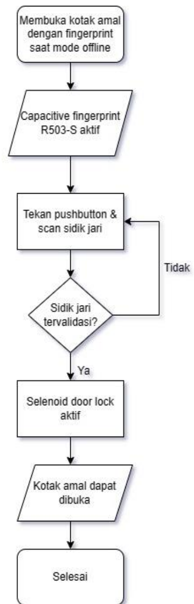
Gambar 3.8 Perancangan Sistem Membuka Kotak Amal Dengan Fingerprint Saat Mode Offline
