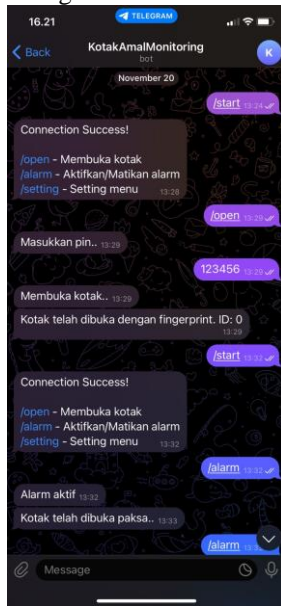
Gambar 4.1 Notifikasi Yang Terkirim Dari ESP32 ke Telegram Bot Jika Terhubung Dengan Internet
