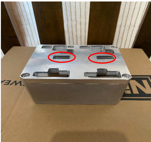
Gambar 10 penambahan profil pada jig support block
