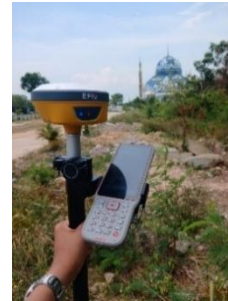
Gambar 2.5 Pengambilan koordinat menggunakan GPS Geodetik - GNSS RTK
