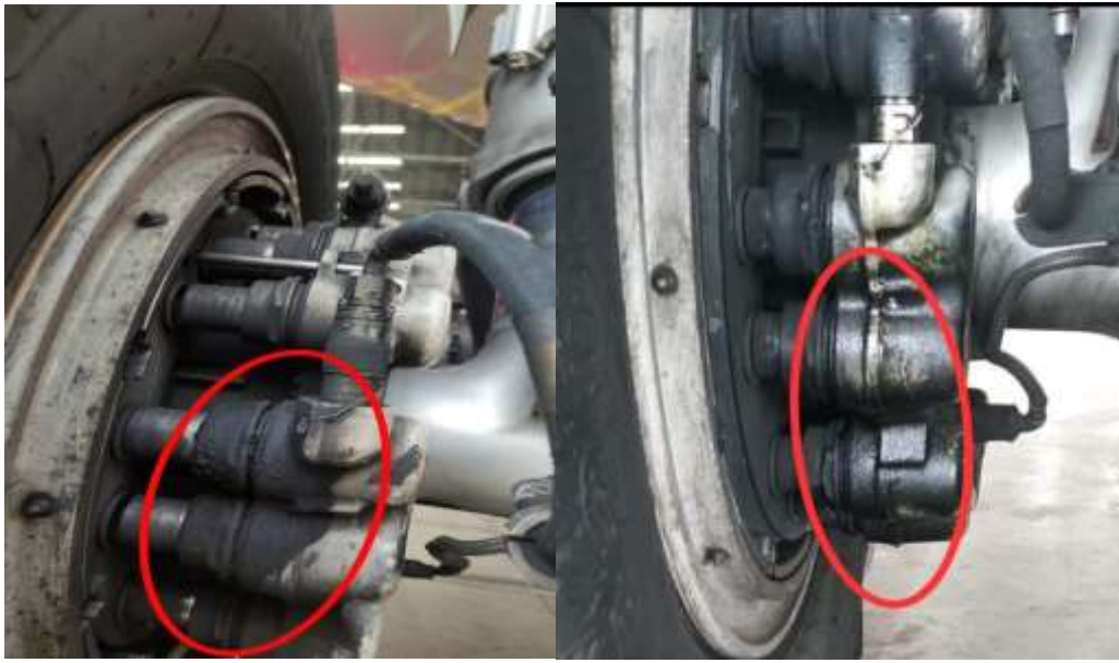
Gambar 4: Leaking seal pada rumah brake pistone.
