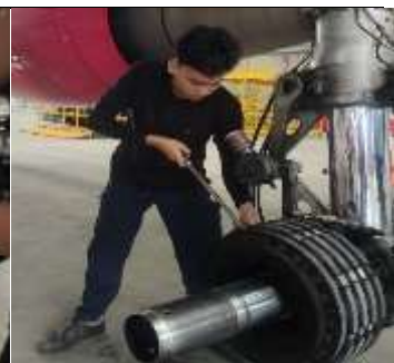
Proses melepaskan Nut pada brake unit .
