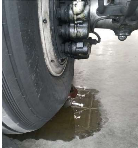
Gambar 3 : pada wheel brake Leak no3
