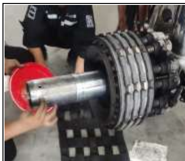
Melapisi outer circumference of the protective tool dengan minyak.
