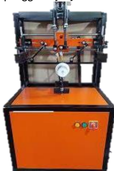
Gambar 3. Mesin Sablon Cup
