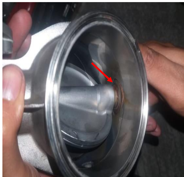
Gambar 8. Korosi pada valve body start valve
