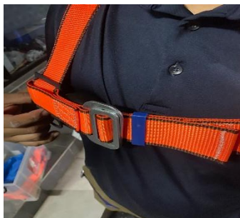
Gambar 16. Posisi Tali Gesper Body Harness Tidak aman
