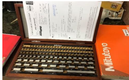
Gambar 4. Gauge Block Mitutoyo (0-200 mm) Beserta sertifikatnya
