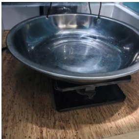
Gambar 24. Mangkok Makan dan Posisi Load Cell
