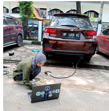
Gambar 9. Proses melakukan uji emisi pada mobil
