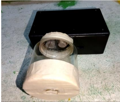
Gambar 8. Alat Pendeteksi Emisi gas buang buatan penulis
