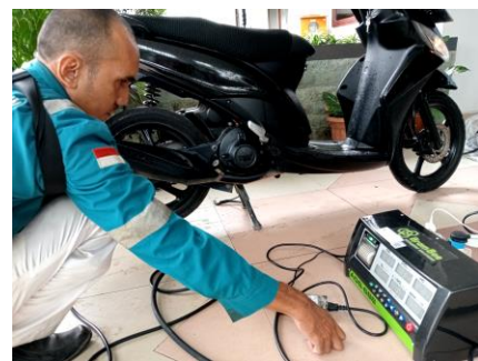
Gambar 10. Proses melakukan uji emisi pada motor
