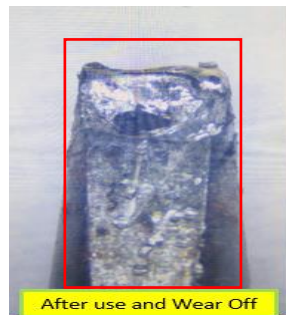
Gambar 17. Tips Solder Aus
