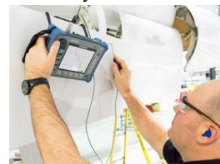
Gambar 9: Ilustrasi pengerjaan NDT HFEC
